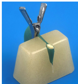
Abb. 2: Versuchsaufbau: Artifizielle parodontale Tasche bestehend aus einem Kunststoffblock und Kofferdam
