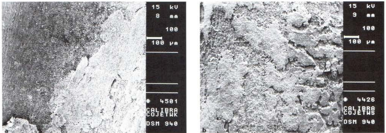
Abbildung 2 Die REM-Darstellung eines kohäsiven Frakturmodus des Befestigungskomposits (Calibra, Dentsply DeTrey, Konstanz) teilweise im Wurzelkanal (a) und teilweise an der Stiftoberfläche (b) verdeutlicht die Vorteile der tribochemischen Stiftkonditionierung des FRC-Stiftes.
