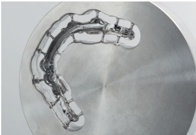
Abb. 23 Gefräster Stegüberwurf im Rohling in der Phase des Feinschliffs.
