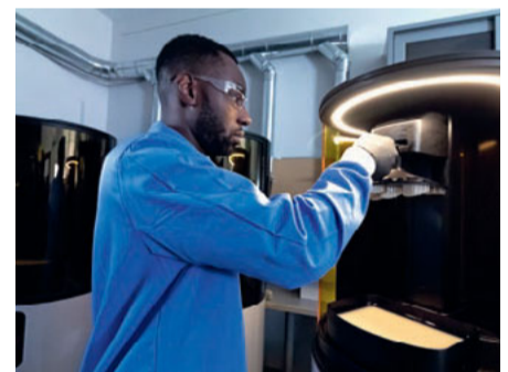
Abb. 3 Die DLS-Technologie (Digital Light Synthesis) ist ein innovatives Druckverfahren, das von Carbon entwickelt wurde, und bei dem ein kontinuierlicher Flüssigkeitsspalt zwischen Belichtungsplatte und dem zu druckenden Teil dazu führt, dass keine Zugkräfte wirken.
