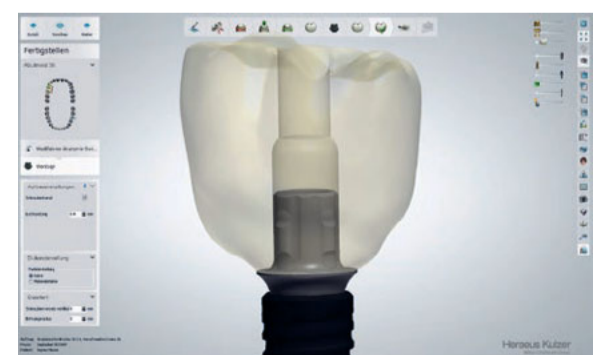
Abb. 2 und 3 Neu im Band III des Curriculum Prothetik ist auch das Thema digitale Workflows bei der Planung und Umsetzung von Implantatprothetik. So kann das Kronen- und Brückendesign heute im digitalen Artikulator erfolgen (oben). Zudem gibt es Keramikblöcke für die CAD/CAM-Technik, in die die notwendige Anschlussgeometrie und der Schraubenzugangskanal bereits integriert sind (unten).
