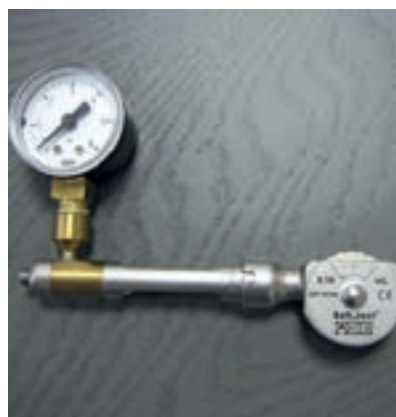
Abbildung 2a–c Softject -Dosierradspritze in Kombination mit Druckmessgerät mit Rohrfeder der Firma WIKA, Klingenberg, gemäß Zeichnung V-1918-01.
