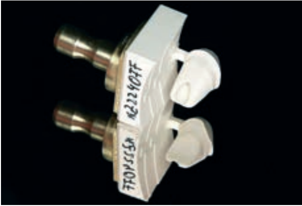
Abbildung 2a Anatoform im CAD/CAM-Verfahren gefräster Abutmentrohling aus Zirkonoxid.
