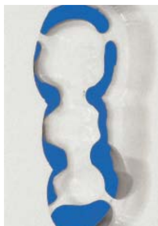
Abb. 13 Brückengerüst nach dem Herausfräsen aus einem Rohling aus HIP Zirkonoxidkeramik.
