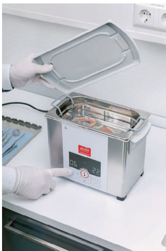
Abb. 7 Für die Prothesenaufbereitung kommt das Programm DYN zum Einsatz. Im Korb lassen sich Ober- und Unterkieferprothese gleichzeitig reinigen.
