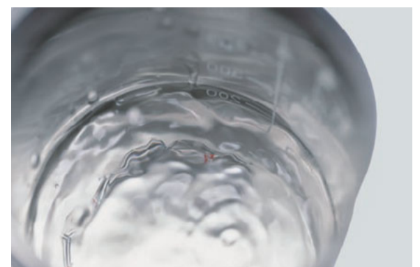
Abb. 5b Ultraschallgeräte wie das Easyclean MD entfernen Verschmutzungen und biologische Schadstoffe mittels einer oszillierenden Welle, Kavitation, akustischer Mikroströmung und der physikalischen Verstärkung der Reinigungslösung.
