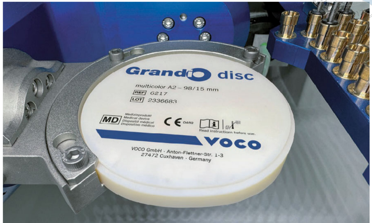
Abb. 1 Die Partnerschaft von Voco mit Dental Machine by Tecno-GAZ sorgt dank einer speziell entwickelten Fünf-Achs-Frästrategie für die präzise Fertigung von Restaurationen aus den Fräsprodukten von Voco, etwa aus der Grandio disc multicolor, mit der sich Restaurationen mit einem natürlichen Farbverlauf von der Schneide zum Zahnhals realisieren lassen.
