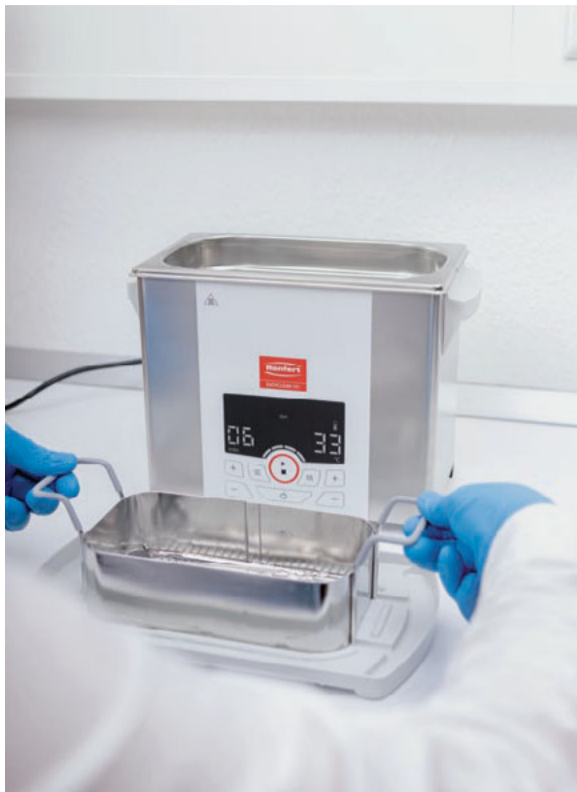
Abb. 6a und b Für die tägliche Reinigung endodontischer Instrumente wird das ECO-Programm verwendet, bei dem der Korb mit maximal sechs bis acht Instrumenten befüllt wird.
