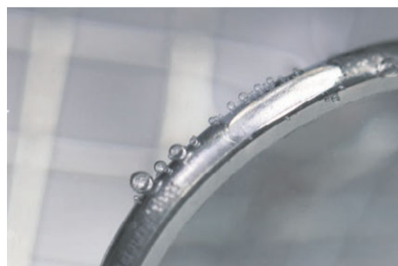
Abb. 5a Der erste Reinigungszyklus sollte ohne Instrumente erfolgen, um Luftschlüsse zu entfernen und die bakterielle Last optimal beseitigen zu können.
