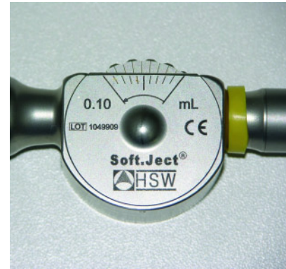
Abbildung 4 Dosierrad zum manuellen Aufbau des Injektionsdruckes.
