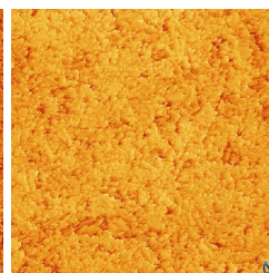
Fig. 7: BICON uncoated SA = 1.96 ±0.05
