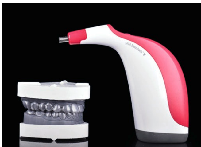
Abb. 9 Spektralfotometer mit Repositionierungsschiene zur Farbmessung. An Zahn 14 und 16 sind die Öffnungen zum Aufsetzen des Messkopfes erkennbar.
