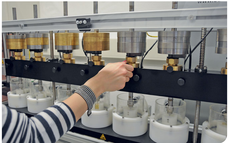
Abb. 2 Einsetzen von Prüfkörpern in den Kausimulator.
