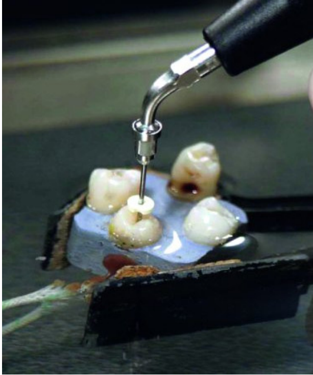
Abbildung 2 Versuchsdurchführung der direkten Methode mit einer eingespannten Kerr-Feile in einem Endfeilenhalter.
