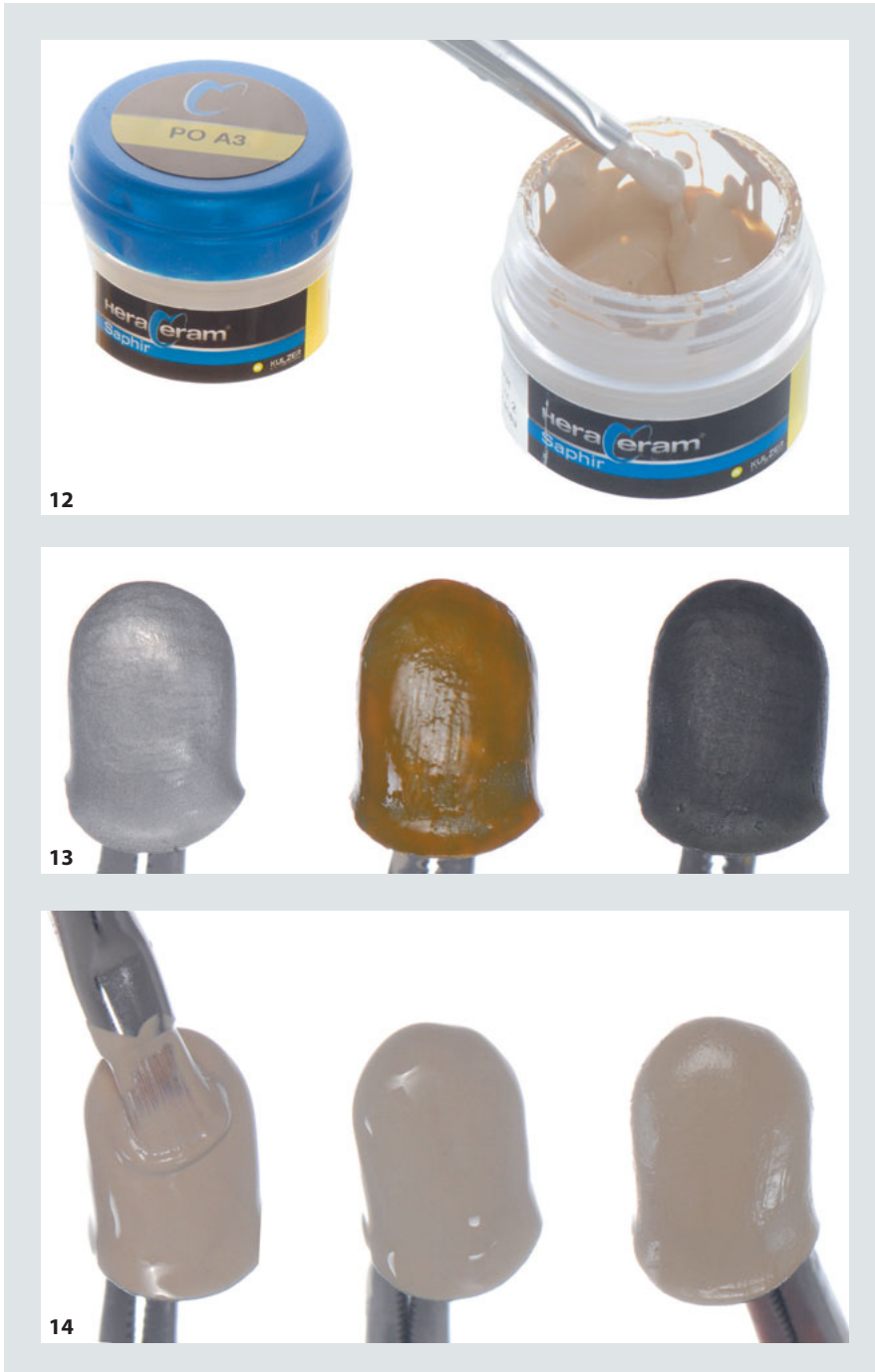
Abb. 12 Eine neue Generation von Pastenopaker ermöglicht maximale Effizienz. Abb. 13 Mithilfe des HeraCeram NP-Primers wird der Oxidbrand eingespart und die Gerüstoberfläche für den Opaker vorbereitet. Abb. 14 Mithilfe der Anhangskraft des neu entwickelten Pastenopakers können die Metallgerüste mit einem Opakerbrand vollständig abgedeckt werden.
