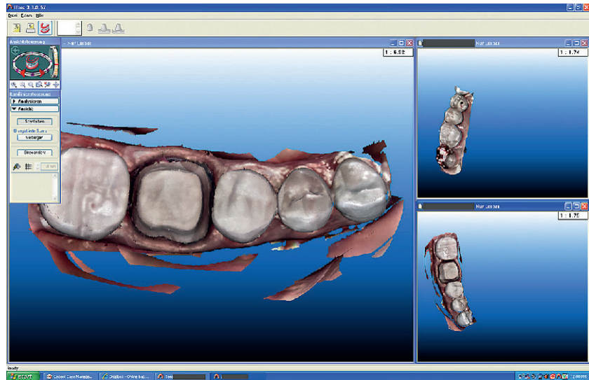
Abbildung 11 Screenshot eines virtuellen Modells des Zahnes 46 (klinisches Beispiel), welches aus Einzelabformungen mit dem iTero Scanner erstellt wurde. Zum Vergleich: Der gleiche Zahn wurde auch mit der Cerec AC abgeformt (s. Abb. 2). Figure 11 Screenshot of a computer model of a lower right first molar, which was calculated by matching single impressions. The same tooth was acquired with Cerec AC (please see figure 2).
