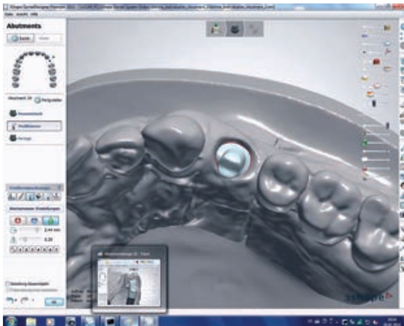
Abbildung 17 Gestaltung des Abutments im Computer.
