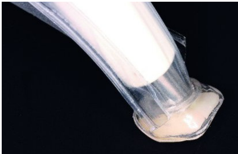
Abbildung 6 Positionierung des Messkopfes (mit Infektionsschutz) auf dem Probekörper mit Schablone.
