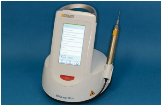
Abb. 2 Lasersystem der Wellenlängen 445, 660 und 970 nm mit vorwählbaren Laserparametern und aufsteckbaren Arbeitsansätzen verschiedener, indikationsbezogener Faserdurchmesser
