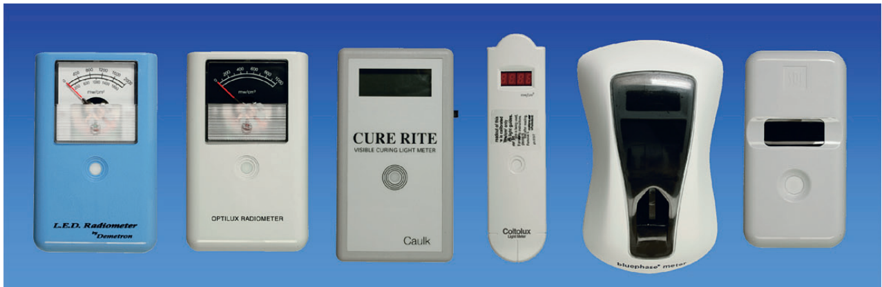
Abbildung 1 Die in der Untersuchung zur Bestimmung der Lichtemissionsleistung verwendeten Hand-Radiometergeräte.
