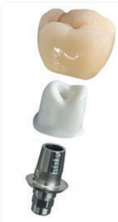
Abbildung 13 Beim Hybridabutment wird das ZrO_2 -Abutment mit der Titanbasis verklebt, die Titanbasis mit dem Enossalpfeiler verschraubt. Das ergibt eine spannungsfreie Verbindung. (Abb. 13: Sirona)
