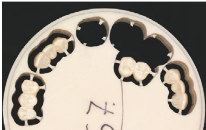
Abb. 14 Gefräste Teile im Blank, okklusale Ansicht.
