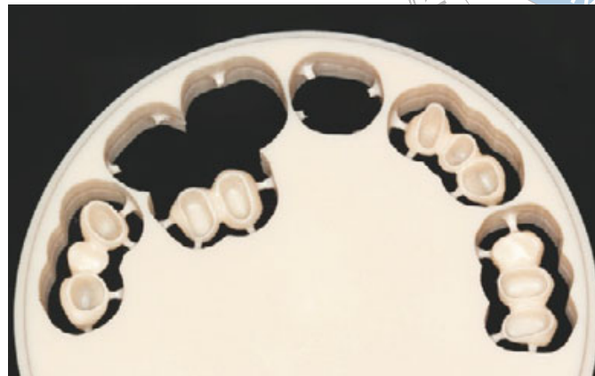
Abb. 15 Gefräste Teile im Blank, basale Ansicht.
