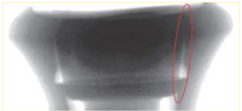
Abb. 17 Inkongruente Konuswinkel verhindern die Selbsthemmung. Die tatsächlich kraftschlüssig wirkende Konushöhe wird sehr klein. Ein Abkippen des Abutments bei extraaxialen Kräften ist möglich.
