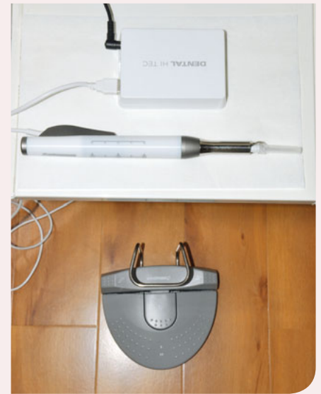
Abb. 1 Komponenten des QuickSleeper-Anästhesiesystems: Steuergerät und Handstück mit motorischem Antrieb für die rotierende Perforation der Kompakta (oben) und die computergesteuerte Injektion sowie kabel- und batterieles Fußpedal mit rechtem Pedal zur Steuerung der Perforation und linkem Pedal zur Steuerung der Injektion (unten).
