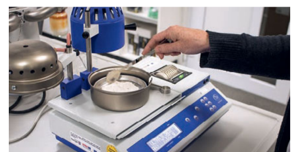
Abb. 3 Nicht alle Gipsabfälle sind uneingeschränkt recycelbar, da Stör- und Zusatzstoffe die Recyclinggipsqualität negativ beeinflussen und eine hochwertige Verwertung erschweren können. Analysen der zu recycelnden Gipsbauprodukte sind daher unabdingbar.
