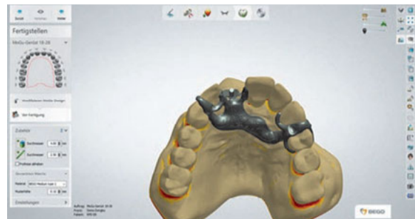
Abb. 2 Das Klammer-Provisorium für den Zahn 11 wurde CAD/CAM-gestützt designt und beim Bego Design- und Fertigungsservice im Selective-Laser-Melting-Verfahren aus Wironium RP produziert.
