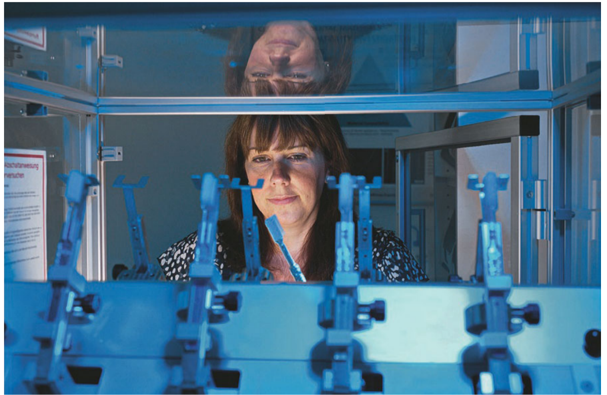
Abb. 1 Für die In-vitro-Studie wurde in einem Zahnputzsimulator die tägliche mechanische Reinigung der Zähne simuliert.
