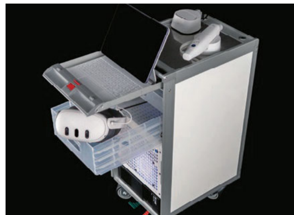
Abb. 1 Die mobile Arbeitsstation Dental Droid von D2D ist eine Art IO-Scanner-Hub. Sie arbeitet ohne Leistungsabfall mit sämtlichen gängigen zahnärztlichen Softwarelösungen und gewährleistet eine einfache Integration in bestehende Praxismanagementsysteme.
