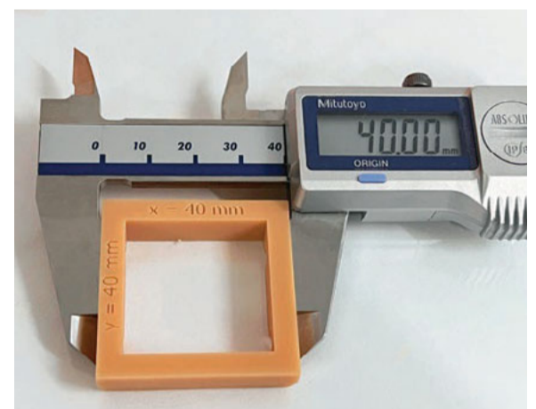
Abb. 3 Prüfkörper aus Water-Washable Dental Model Resin mit Messschieber; das Soll-Maß von 40 mm wurde wiederholt genau abgebildet.
