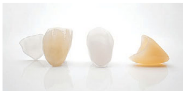
Abb. 2 Der 3-D-Drucker von Lithoz ist in der Lage, im sogenannten LCM-Verfahren Kronen, Veneers, Brücken und Gerüste aus diversen keramischen Materialien additiv zu fertigen.
