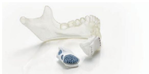
Abb. 3 Ebenfalls sehr interessant ist die Möglichkeit des keramischen Multimaterialdrucks. Mit einer eigens dafür entwickelten 3-D-Druck-Anlage werden bei Lithoz damit Multimaterialdrucke wie zum Beispiel Knochenersatz nach biomimetischem Ansatz realisierbar.
